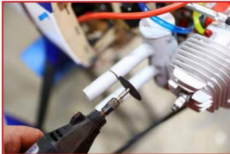
Pour cette installation d'un silencieux J&A Pitts, nous avons coupé un peu plus d'un pouce (25 mm) de la longueur des tubes de sortie pour permettre au capot de glisser dessus.
