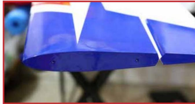
Les trous dans l'extrémité de l'aile correspondent à ces trous dans les SFG et les extrémités des ailes.
