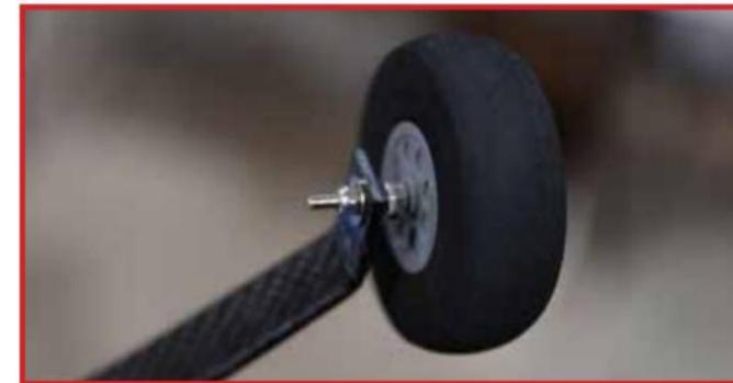
Faites glisser les colliers de roue sur les essieux, puis sur les roues principales, puis sur les colliers de roue extérieurs. Les colliers de roue positionnent les roues sur les essieux. Lorsque vous installez les pantalons, vous devrez affiner l'emplacement des roues. Appliquez une goutte de Loctite sur les vis de réglage des colliers de roue et serrez-les.
