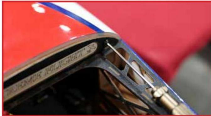
Installez le capot en le faisant glisser vers le haut sur les crochets inférieurs, depuis le bas, et en installant les deux vis du capot comme indiqué.
