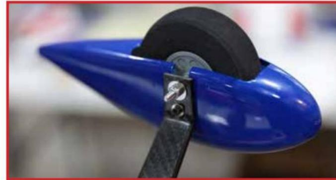
Installez les carénages de roue sur le train d'atterrissage. Appliquez du Loctite sur les vis de 3 mm et installez-les complètement dans les écrous borgnes, puis serrez comme indiqué.
