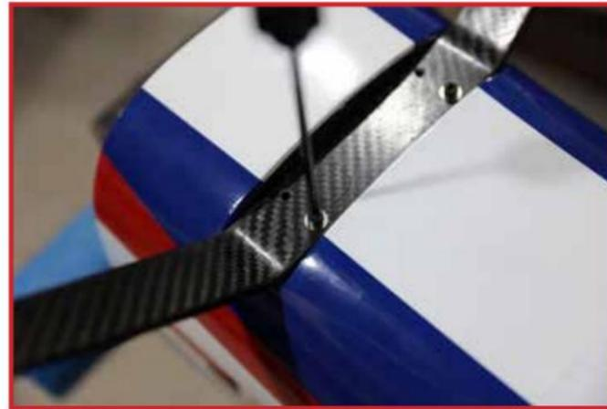
Les carénages reliant le train d'atterrissage au fuselage sont fixés au train d'atterrissage et au fuselage à l'aide d'un adhésif silicone de type Shoe-Goo. Tout d'abord, faites glisser les carénages sur le train et vérifiez leur ajustement pour déterminer l'avant et l'arrière.
