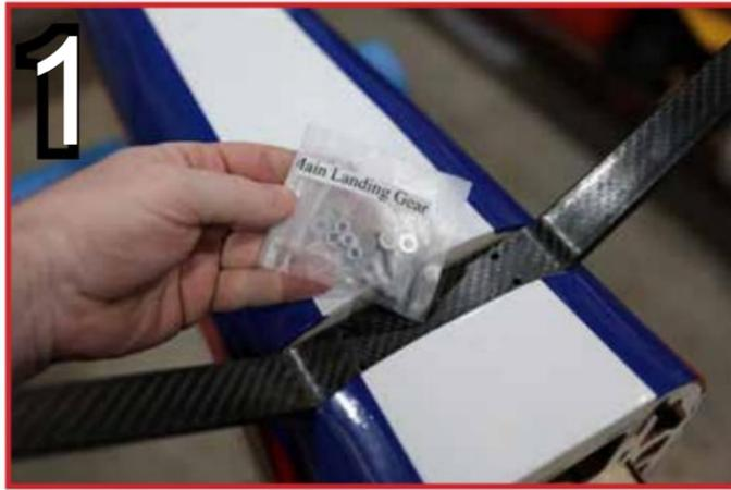
Fixez le train d'atterrissage au fuselage à l'aide des vis de 4 mm, des rondelles et des écrous nyloc. Vous devrez utiliser une pince pour maintenir les écrous nyloc à l'intérieur du fuselage pendant que vous serrez les vis.
