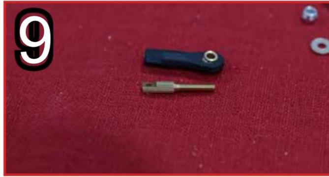
La connexion du gouvernail se fait par câble de traction. Les extrémités des câbles sont réalisées en vissant les embouts de câbles en laiton dans les rotules en nylon.
