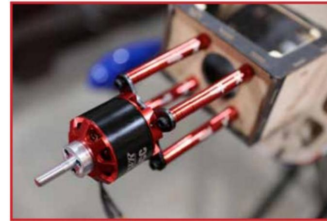
Le moteur XPWR 30CC fournit plus de 3000 watts de puissance et est parfait pour ce modèle.
