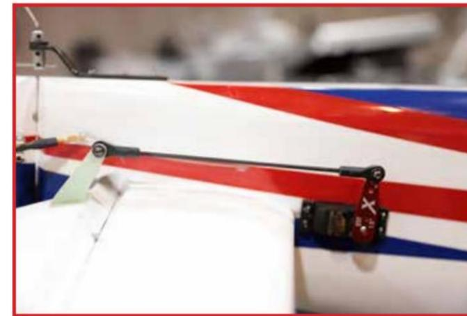
Appliquez de la colle époxy sur le guignol du gouvernail, là où il sera à l'intérieur de la fente du gouvernail. Appuyez sur le guignol dans le gouvernail jusqu'à ce qu'il soit centré. Assemblez la rotule et la vis du côté opposé, assurez-vous que l'assemblage du guignol est centré et ajoutez les plaques de guignol carrées avec de l'époxy comme indiqué. Nettoyez tout excès d'époxy avec de l'alcool et laissez durcir.
