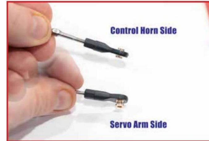
Notez que le Slick 580 EXP de 74 pouces utilise deux types de rotules différents. L'une est symétrique et est utilisée sur les guignols en fibre de verre des surfaces. L'autre est asymétrique, avec un piédestal surélevé d'un côté, et elle est utilisée sur les bras de servo.
