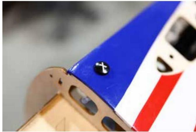
Installez un point de carburant Extreme Flight RC comme indiqué sur le côté du fuselage.
