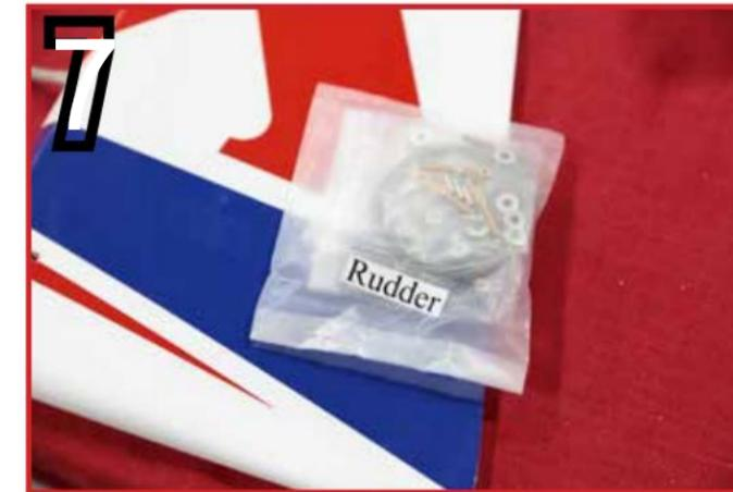
Localisez le gouvernail et le pack de matériel du gouvernail. Les charnières du gouvernail seront installées dans le fuselage et le gouvernail en utilisant exactement la même technique que celle que vous avez utilisée pour installer les charnières de l'élévateur à l'étape 4. Une fois le gouvernail installé, laissez l'époxy durcir.
