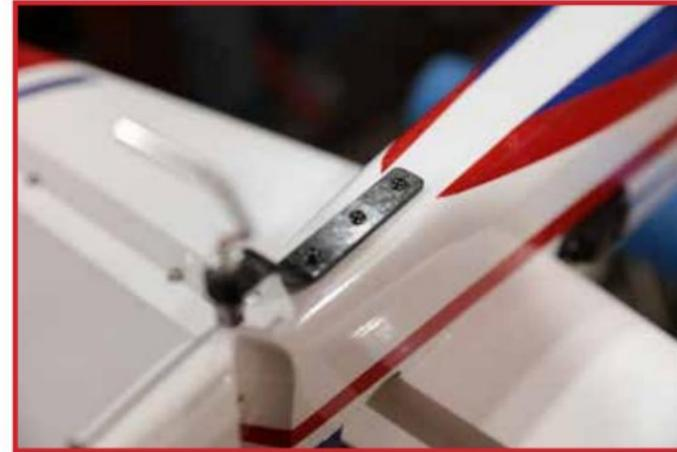
Installez les deux colliers de roue de queue et la roue de queue comme indiqué. Utilisez du Loctite sur les vis de réglage des colliers.
