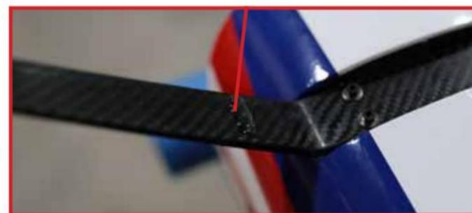
Déposez une grosse quantité de colle gluante sur la jambe du train comme indiqué, puis faites glisser les carénages dans les jambes du train. La colle gluante remplira l'extrémité des carénages. Déposez une noisette supplémentaire de Goo à l'endroit où les carénages entrent en contact avec le fuselage. Laissez sécher le Goo pendant que vous installez les roues et les carénages de roue.
