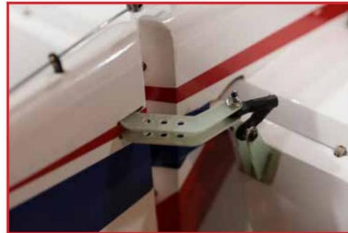
À l'aide de trois vis à bois, installez la roulette de queue comme indiqué. L'axe de pivotement de la roulette de queue doit être aligné avec les charnières du gouvernail. Au fur et à mesure que vous installez chaque vis, vissez-la à moitié, puis retirez-la et ajoutez une goutte de colle CA dans le trou, puis vissez la vis à fond.
