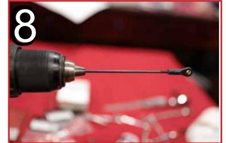
Installez le bras de servo et la tige de poussée. Nous recommandons les bras de servo en aluminium Extreme Flight RC. Sur la photo, un bras de 1,5", mais nous recommandons un bras de 2,0" pour des options maximales de course de contrôle. Installez la tige de poussée avec du matériel de 3 mm, notez que vous devez utiliser soit un écrou nyloc, soit du loctite sur la vis qui fixe la rotule au bras de servo.
