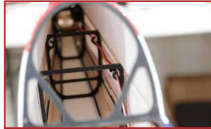
Le Slick est doté de crochets pour fixer le câble de votre servo dans le fuselage.
