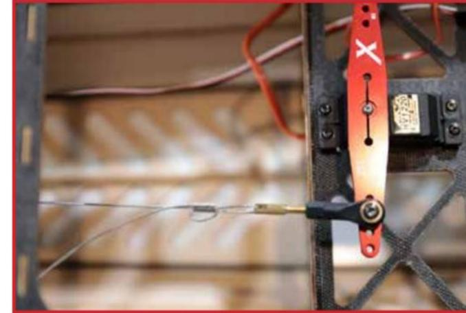
Notez que même si nous avons besoin que nos câbles de gouvernail soient bien serrés, et non pas lâches ou tombants, nous ne voulons pas non plus qu'ils soient trop serrés. Nous ajustons nos câbles avec le servo et le gouvernail au centre pour qu'ils soient bien serrés. Des câbles trop serrés exercent une pression supplémentaire sur le servo de gouvernail. De plus, il est normal que les câbles aient un peu de mou d'un côté à pleine déflexion.
