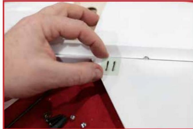
Si nécessaire, nettoyez les fentes de l'élévateur de toutes les fibres de bois parasites afin que le klaxon de commande puisse être facilement inséré.
