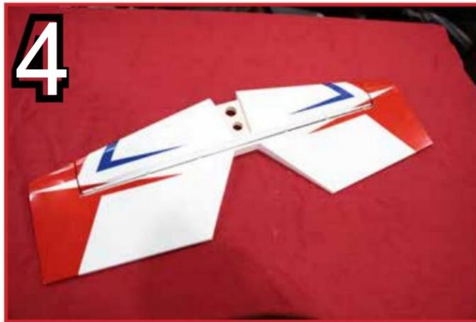
Localisez le stabilisateur horizontal et les élévateurs. Dans cette étape, nous allons articuler les élévateurs et nous allons articuler toutes les autres surfaces de la même manière. Notez que pour l'articulation, nous utiliserons du spoxy 30 minutes comme adhésif et de l'alcool dénaturé et un chiffon pour le nettoyage.
