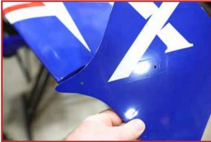
Vissez les extrémités des ailes et les SFG comme indiqué. Étant donné que ces pièces doivent être retirées pour le transport de l'avion, ne fixez pas ces vis avec du Loctite.
