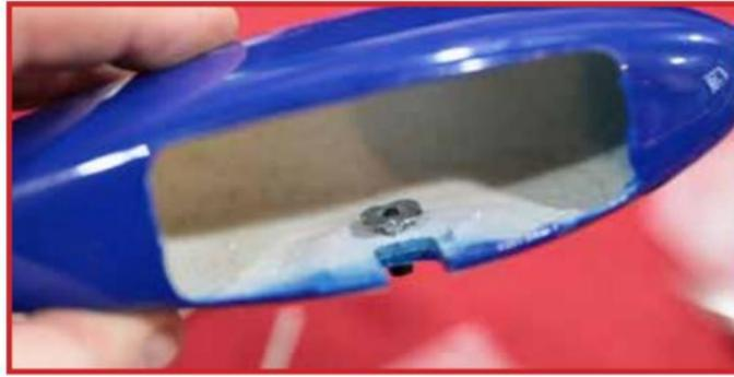
Augmentez la taille du foret jusqu'à ce que vous puissiez enfoncer l'écrou borgne dans le trou comme indiqué. Utilisez la vis et la rondelle de 3 mm pour enfoncer partiellement l'écrou borgne dans le trou et les pointes de l'écrou borgne s'engagent dans la fibre de verre.
