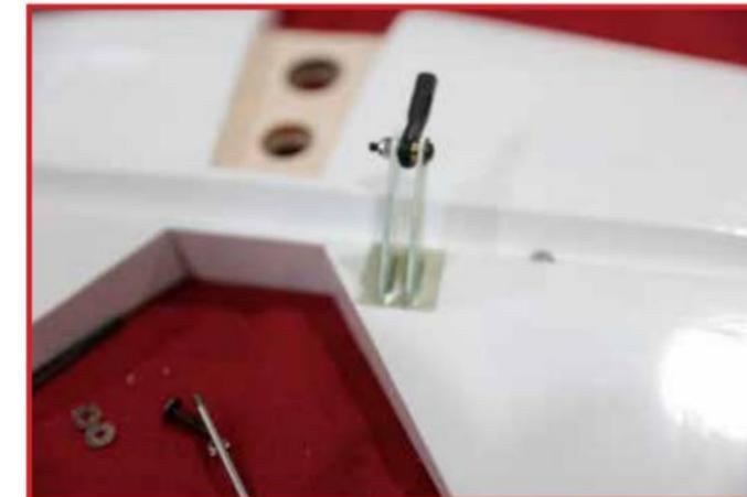
Placez la plaque de base sur le klaxon comme indiqué, mélangez un nouveau lot d'époxy 30 minutes et enduisez la plaque de base et les pieds de l'assemblage du klaxon d'époxy. Placez plus d'époxy dans les fentes de l'élévateur et insérez l'assemblage du klaxon. Nettoyez tout excès d'époxy qui en sort. Laissez durcir.
