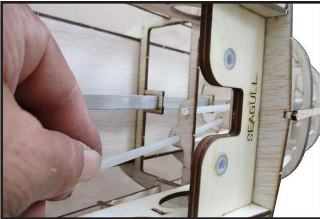
Assemblez les bandes de balsa 4x4mm (4pcs) sur chaque ancien fuselage afin de relier l'ensemble de l'ancien fuselage et de soutenir la tôle de recouvrement comme (photo 63,64).
