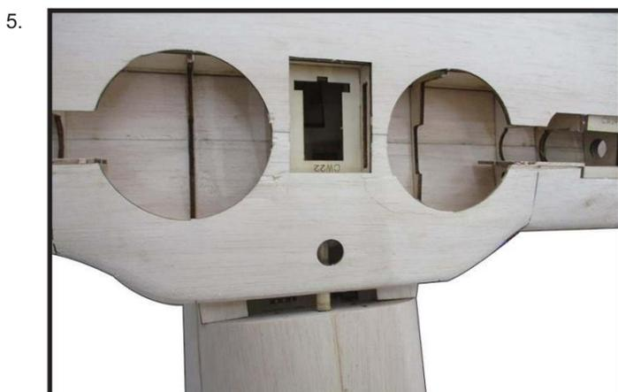
Utilisez la vis pointue pour marquer le point de repère afin de localiser le trou. Ensuite, placez l'aile sur le fuselage et appuyez légèrement sur la pointe (prenez deux points). Étape suivante, à partir du point central, percez deux trous ( $\varnothing$  6 mm) qui sont les trous de boulon pour fixer l'aile au fuselage. (Photo 6, 7).
