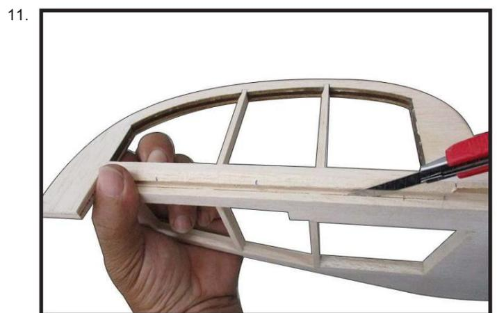
Localisez la position du fil de jonction de l'élévateur métallique. Ensuite, percez le puits rond ( $\varnothing$  3 mm) à l'intérieur de l'élévateur. La valeur profonde du puits est égale à la dimension de la partie du fil qui se plie à un angle de 90 degrés comme un crochet. (Photo 12).
