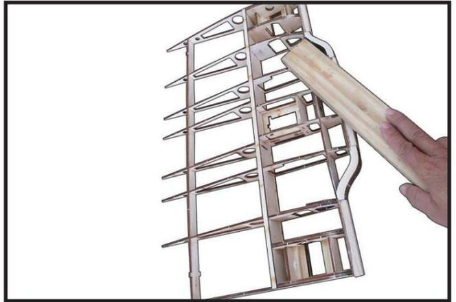
Localisez et assemblez le tube d'aile. Poncez légèrement le tube d'aile pour qu'il puisse passer facilement dans les trous comme le montre la photo (photo 29).
