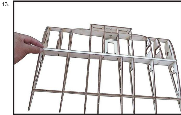
Localiser et assembler le CW19 (support d'engrenage) par colle époxy comme (photo 14,15).
