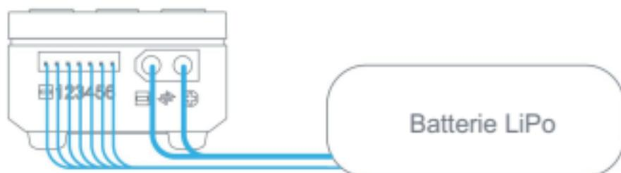
Connexion de batterie au lithium avec adaptateur d'équilibrage
