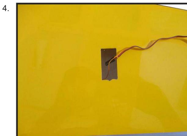
Fixez le câble du servo au servo de l'aileron. Attachez la ficelle au câble du servo et faites-la passer avec précaution dans l'aile. Une fois que vous avez passé le câble dans l'aile, retirez la ficelle pour pouvoir l'utiliser pour l'autre câble du servo.
