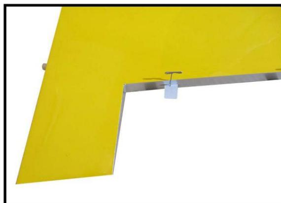
Faites glisser le panneau d'aile sur l'aileron jusqu'à ce qu'il n'y ait qu'un léger espace. La charnière est maintenant centrée sur le panneau d'aile et l'aileron. Retirez les goupilles en T et serrez l'aileron contre le panneau d'aile. Un espace de 1/64" ou moins doit être maintenu entre le panneau d'aile et l'aileron.
