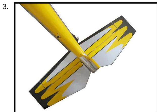
Tout en maintenant fermement le stabilisateur vertical en place, utilisez un stylo et tracez une ligne de chaque côté du stabilisateur vertical là où il rencontre le haut du fuselage.
