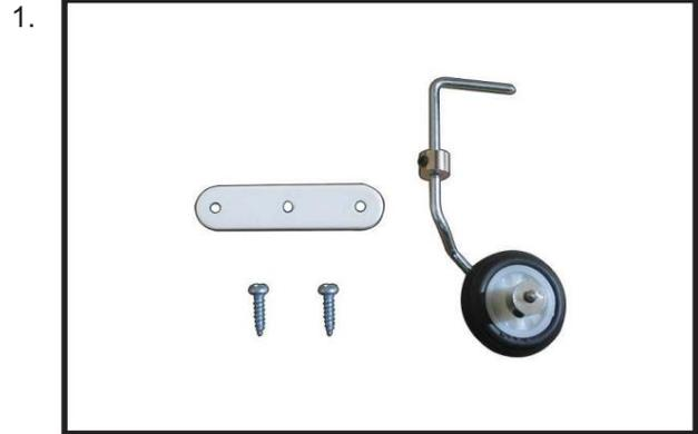
Testez le train arrière pour vous assurer qu'il est correctement installé. Lorsque vous êtes satisfait puis fixez le train arrière à l'aide des deux vis à bois M3x20mm.
