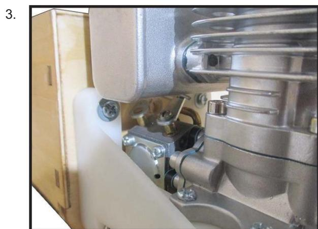
Installez le connecteur servo réglable dans le bras servo
