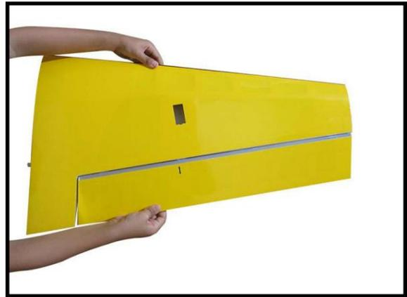
Retournez le panneau d'aile et dévissez l'aileron dans la direction opposée depuis le côté opposé. Appliquez de la colle C/A fine sur chaque charnière, en vous assurant que la colle C/A pénètre à la fois dans l'aileron et dans le panneau d'aile.
