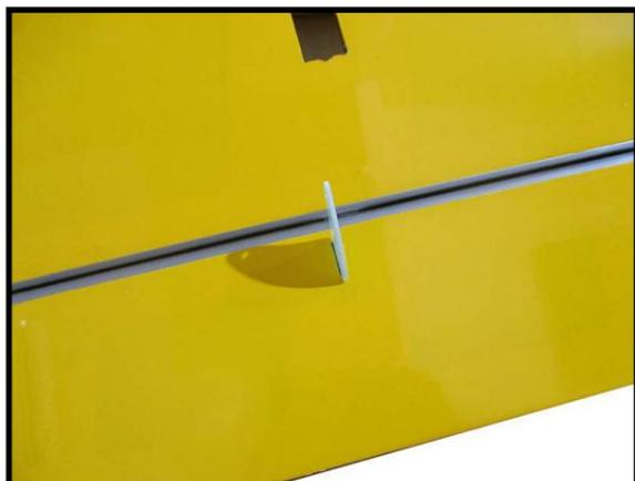
Placez du ruban adhésif à faible adhérence à 1/32 pouce (1 mm) de la fente du guignol. Cela empêchera l'époxy de pénétrer sur la surface de contrôle lorsque les guignols sont collés en place.
