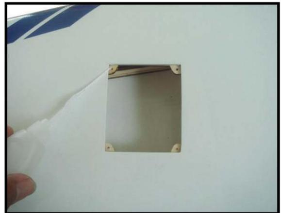
8) Une corde a été prévue dans l'aile pour tirer le câble de l'aileron jusqu'à la racine de l'aile. Retirez la corde de l'aile à l'emplacement du servo et utilisez le ruban adhésif pour la fixer à la rallonge du servo. Tirez le câble à travers l'aile et retirez la ficelle.
