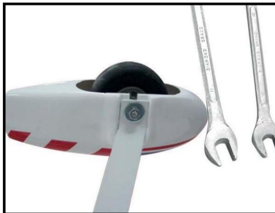
3) Une goutte de colle C/A sur les vis du collier de roue aidera à les empêcher de se desserrer pendant le fonctionnement.
