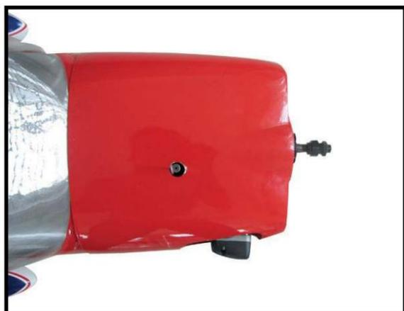
2) Tout en gardant le bord arrière du capot en correspondance avec les marques, alignez l'avant du capot avec le vilebrequin du moteur. L'avant du capot doit être positionné de manière à ce que le vilebrequin est presque au milieu du capot Ouverture. Utilisez la plaque arrière du spinner comme guide. Maintenez fermement le capot en place à l'aide de morceaux de ruban adhésif.
