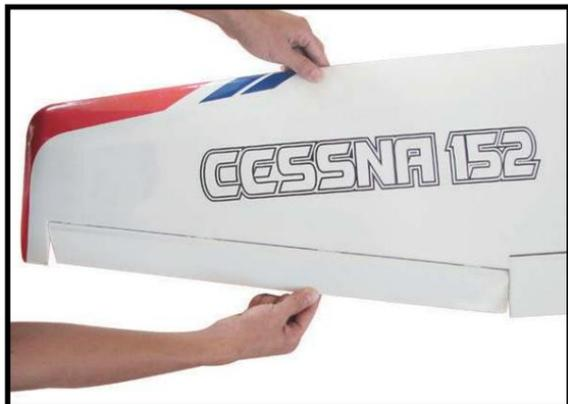
5) Retournez le panneau d'aile et retirez le aileron dans la direction opposée à celle de côté opposé. Appliquez une fine colle C/A sur chaque charnière, en s'assurant que le C/A pénètre à la fois dans l'aileron et dans le panneau d'aile.
