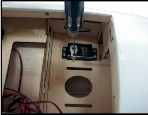
8) Déplacez la manette des gaz en position fermée et déplacez le carburateur en position fermée. Utilisez une clé hexagonale de 2,5 mm pour serrer la vis
