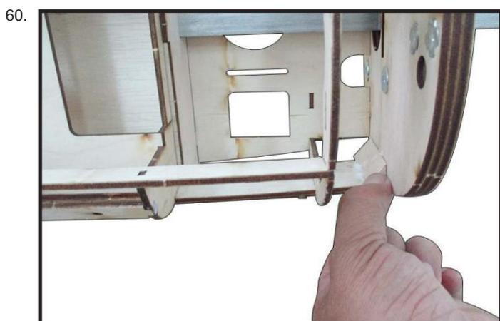
Fixez le tube de tige de poussée en plastique au trou de tige de poussée de chaque ancien fuselage comme indiqué sur la photo (photo 61).
