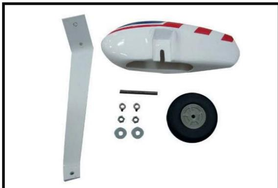
2) Suivez le schéma ci-dessous pour l'installation du carénage de roue :
