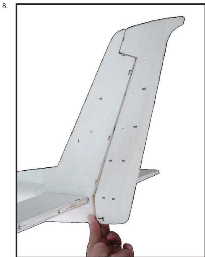
Ponçage du bas arrondi du gouvernail pour qu'il paraisse homogène avec le fuselage.
