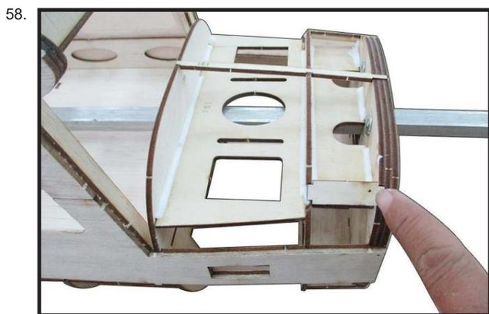
Localisez et assemblez F27 (le support du boulon pour la trappe du fuselage) comme (Photo 59).
