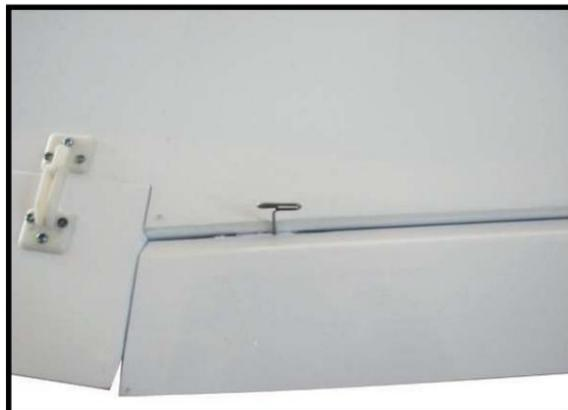
4) Retirez l'aileron et imprégnez complètement chaque charnière avec de la colle C/A fine. La surface avant de l'aileron doit être légèrement en contact avec l'aile pendant cette procédure. Idéalement, lorsque les charnières sont collées en place, un espace de 1/64" ou moins sera maintenu sur toute la longueur de l'aileron jusqu'à la ligne de charnière du panneau d'aile.
