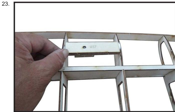
Localiser et assembler le verrou du tube d'aile W21 à W4, W5 avec de la colle CA comme indiqué (Photo 24).
