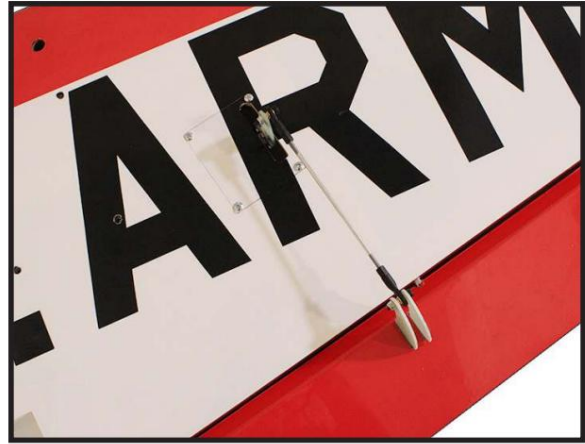
INSTALLATION DE LA TIGE DE POUSSÉE DU VOILET
