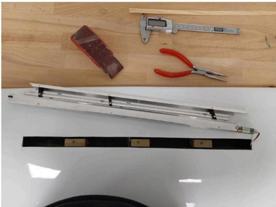
Une fois les positions des blocs de bois déterminées, les blocs de bois sont collés dans la découpe au bas de la surface à l'aide d'un adhésif approprié.
