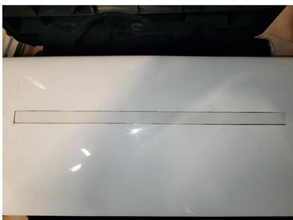
Rétractez les spoilers. Fabriquez un couvercle adapté à partir d'une feuille de plastique blanche de 1 mm d'épaisseur pour recouvrir la découpe et ajustez-le de manière à ce que le couvercle ne se coince pas dans la découpe. Utilisez un adhésif approprié pour coller le couvercle sur le spoiler -
