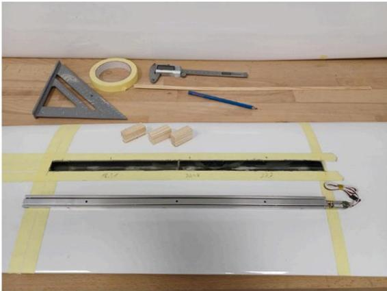
Placez les blocs de bois dans la découpe de manière à ce que les trous de montage situés sous le becquet soient alignés.
