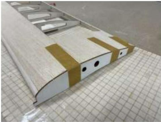
Couper la bande triangulaire pour les ailerons à 730 mm et à la fin s'adapter au parcours de la barre d'extrémité (sable)
