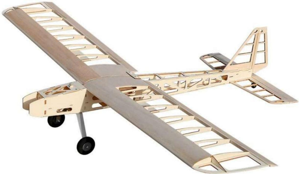
Une fois la coque terminée, le modèle peut être recouvert. Nous recommandons le film thermocollant en polyester.
