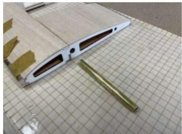
Coller le tube en laiton avec un surplomb de 3 mm. NE PAS coller encore la nervure d'extrémité A7.
