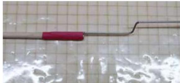
Vissez les cornes de commande en plastique sur les surfaces de contrôle respectives des ailerons, du gouvernail et de l'élévateur et connectez les tiges de commande ou les tiges de poussée aux servos. Du côté du servo, le fil peut être plié en forme de Z, et du côté du gouvernail, une tête de fourche est utilisée.
