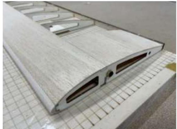
Poncez la bande d'extrémité en haut et en bas jusqu'à un point vers l'extrémité de l'extrémité de l'aile, comme l'exige le biseau du longeron.
