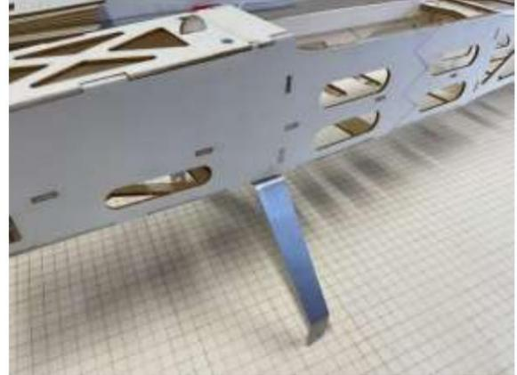
Assemblage du train d'atterrissage arrière
