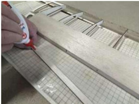
Coupez des pièces de planches à partir de planches de balsa de 1,7 mm d'épaisseur à une longueur qui couvre les 3 premières nervures A1 à A3.
