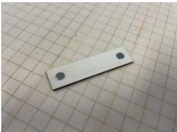
Collez les deux broches C7 dans la pièce C2. Le composant C8 est collé dans la fente centrale (non représentée).
