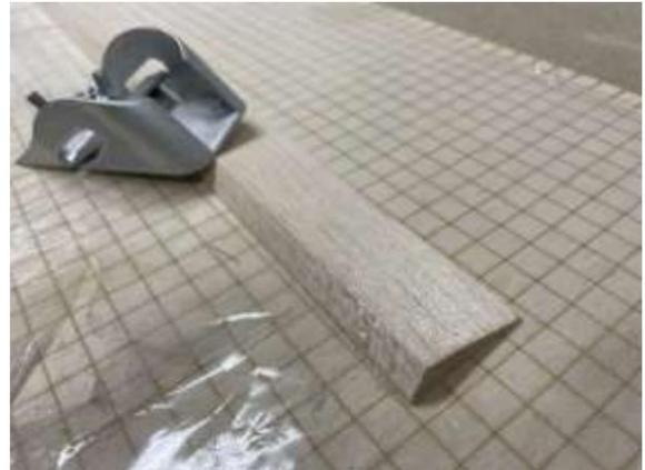
Marquez une ligne centrale sur la pièce en contreplaqué B10 et utilisez-la comme guide de perçage pour les vis à oreilles.
