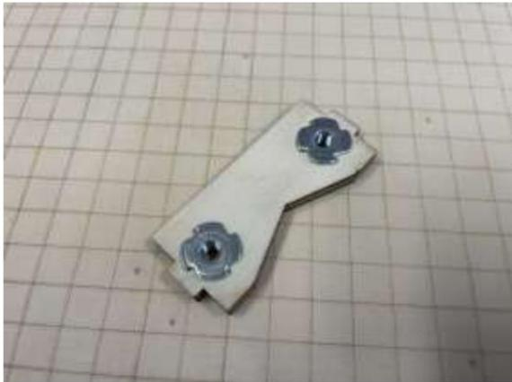
Collez la carte servo, B8 et C5. La goupille de B8 doit pointer vers le bas, elle s'engagera plus tard dans le plancher du fuselage
