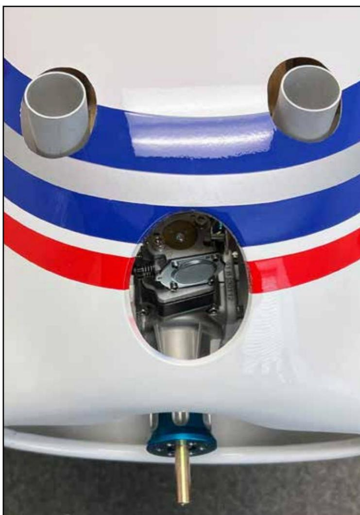
10. Si vous utilisez des silencieux à cartouche ou des tuyaux réglés, le tunnel d'échappement inclus dans ce kit n'est pas suffisant et le couvercle du capot s'est avéré plus que suffisant pour les vols par temps chaud.
