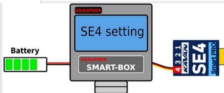
Connexion SMART-BOX en option. La sortie n°4 doit être configurée sur l'option « Ch4 : Sensor EX » et le signal SUMD doit être détecté sur le connecteur MR30.
