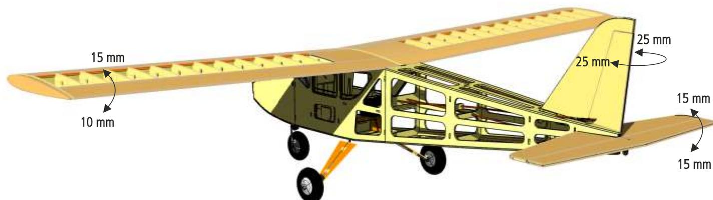
**Version à moteur électrique :** Montez la propulsion et connectez le variateur, le moteur et les servos ; ne montez pas encore l'hélice. Branchez l'accu de propulsion et réglez les débattements de volets comme indiqué. Fixez l'accu avec de la bande auto agrippante sur le platine accu, puis vérifiez l'équilibrage du modèle terminé avec l'accu. Le centre de gravité se trouve à 65mm derrière le bord d'attaque. Autant que possible, réglez la position du centre de gravité en déplaçant l'accu.
