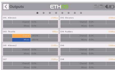
La plage de canaux est configurable en appuyant sur les barres de canaux, veuillez également vous assurer de la configuration des canaux avant d'utiliser le module.
