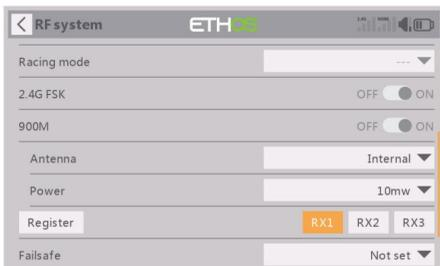
Déplacez le curseur sur RX1 [BIND], appuyez dessus et remettez le récepteur sous tension.
