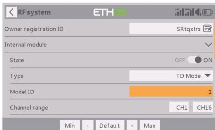
Le système attribue automatiquement un numéro de modèle au récepteur lors de la création d'un nouveau modèle. (L'ID de modèle peut être défini entre 00 et 63, la valeur par défaut étant 1.)
