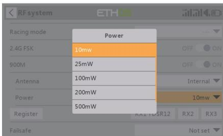
Ouvrez la barre de menu Alimentation et sélectionnez le niveau de puissance souhaité en fonction de l'utilisation.
