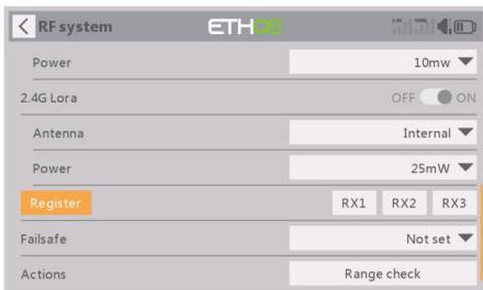
Pour le mode TW par exemple, sélectionnez l'option [Enregistrer] pour mettre la radio en état d'enregistrement dans l'outil RF System-Internal Module, puis appuyez sur le bouton F/S du récepteur et allumez le récepteur.
